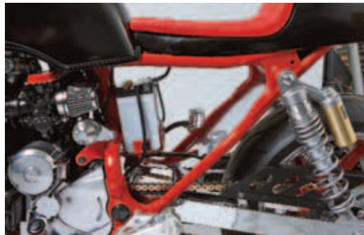
Der Wegfall des Luftfilterkastens sorgt für ein luftiges Gefühl im Rahmendreieck (l. o.). Die Louis-Honda rollt auf Dunlop Qualifier und bremst mit Racing-Scheiben von Lucas (l. u.).
