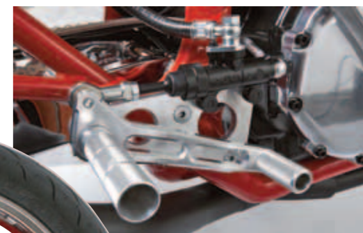
Auch bei der Fußrastenanlage von Gimbel handelt es sich um eine Sonderanfertigung.
