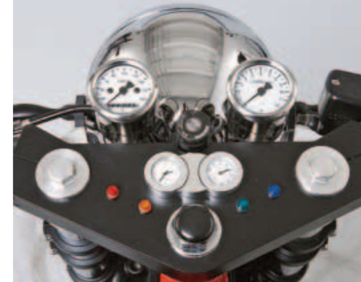
Die eigens angefertigte Gabelbrücke trägt Thermometer, Uhr und die Halter für Tacho und Drehzahlmesser.
