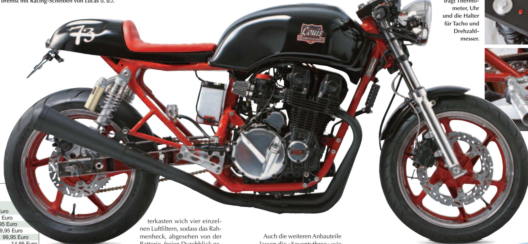
Der Wegfall des Luftfilterkastens sorgt für ein luftiges Gefühl im Rahmendreieck (l. o.). Die Louis-Honda rollt auf Dunlop Qualifier und bremst mit Racing-Scheiben von Lucas (l. u.).
